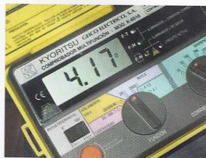
Medición de la toma de tierra ( \Omega )
